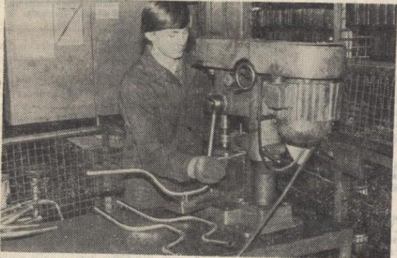
Ten pracownik pracuje na wiertarce w rękawicach. W każdej chwili maszyna może wkręcić rękawicę i rękę.
